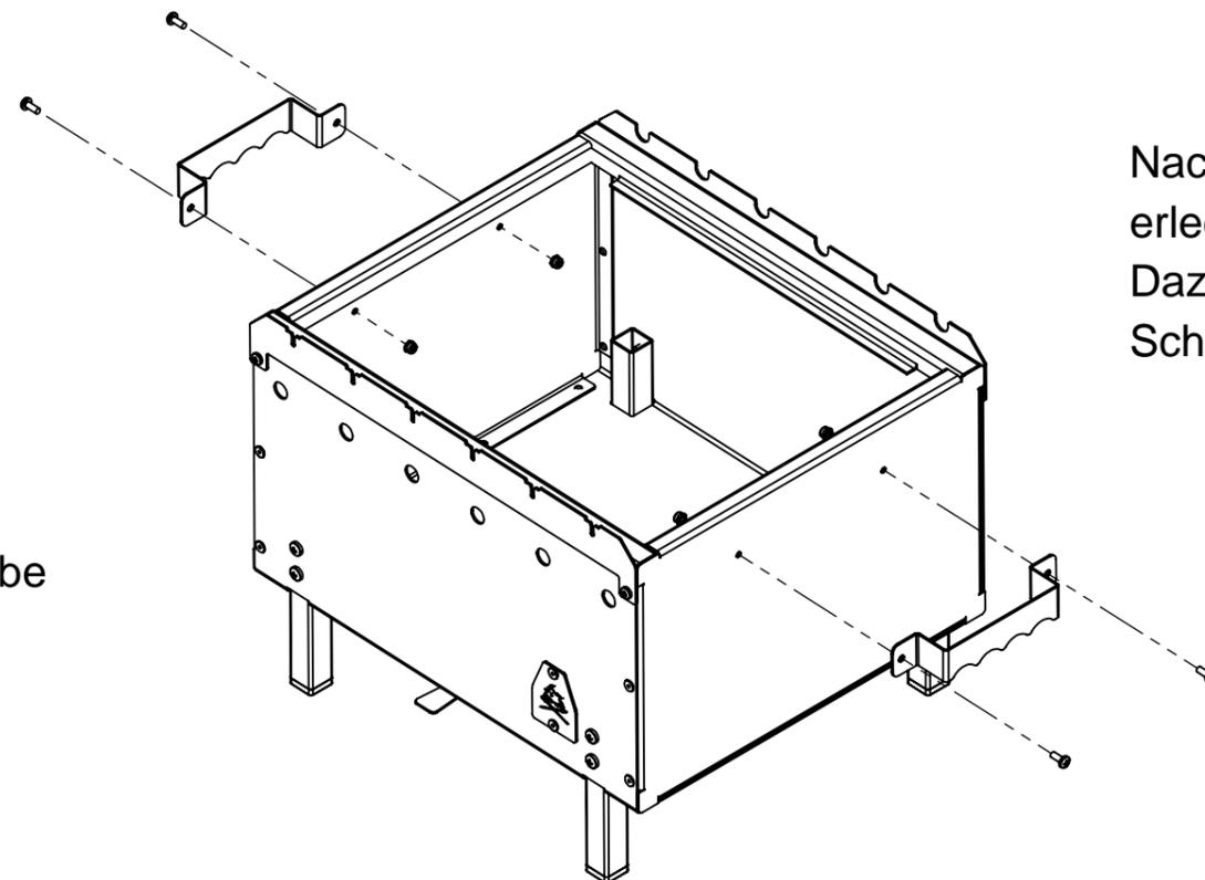
Nachdem der erste Schritt mit den Füßen erledigt ist können die Griffe montiert werden. Dazu wie abgebildet 4x M4 Muttern wie auch Schrauben mit den Griffen Fixieren.
